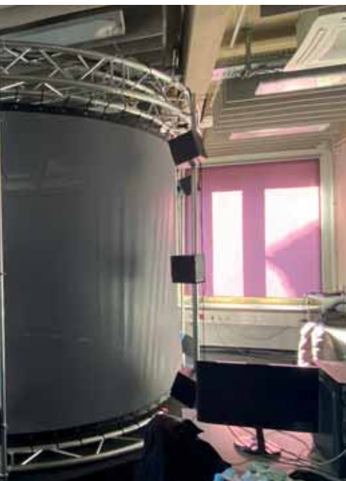
Außenansicht des 3D-Audio Domes. Die gut erkennbaren Lautsprecher beschallen eine für den Schall transparen- te Akustikleinwand.
