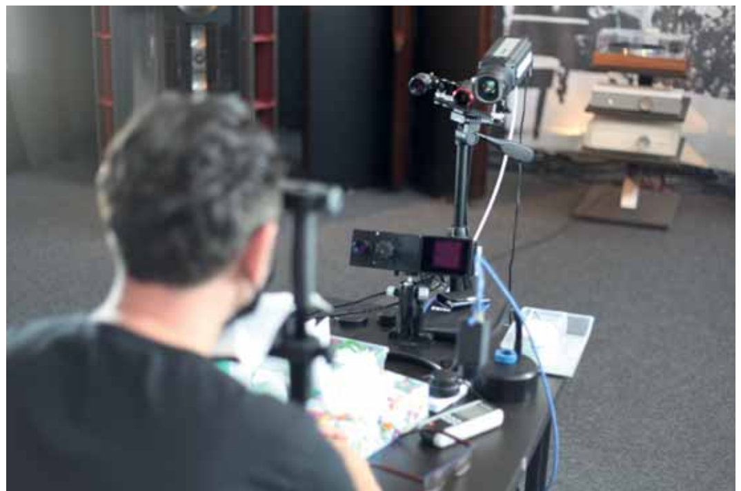
Einrichtung des Messplatzes für die Messung von Immersion beim Musikhören im Backes&Müller Hörraum. Zum Einsatz bei diesem Hörtest kamen die BMLine 35.
